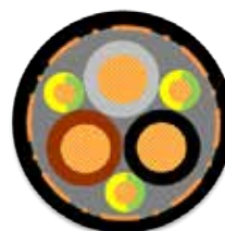
Sección del cable.
