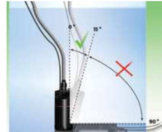
Versión SB: Instalación vertical o ligeramente inclinada - No se puede instalar horizontalmente.
