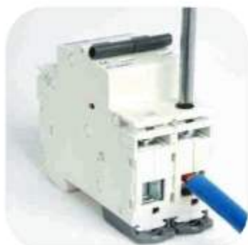
Terminal de seguridad: fácil cableado; Grado de protección IP20. Tornillo Pozidriv y cabeza ranurada. Par de apriete hasta 2,8 N-m
