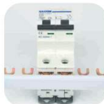
Los MCB y RCCB se pueden conectar con peines tipo FORK tanto en los terminales superior como inferior, con fácil extracción del carril DIN
