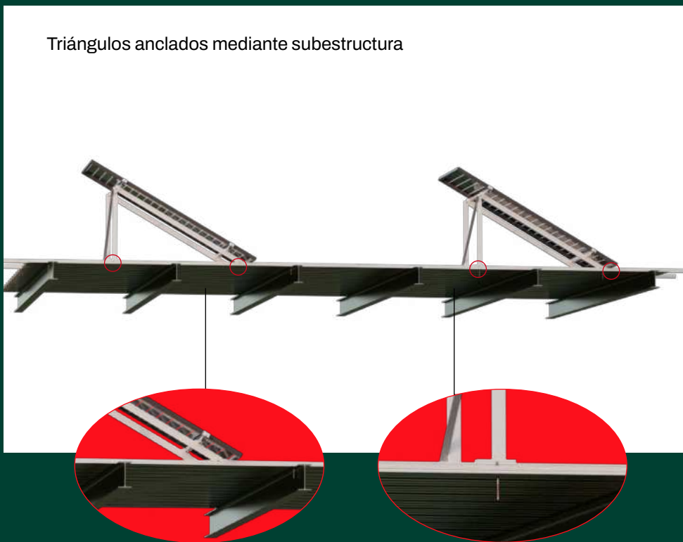
Subestructura no anclada a todas las correas disponibles
