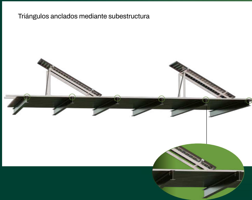
Subestructura anclada a todas las correas disponibles
