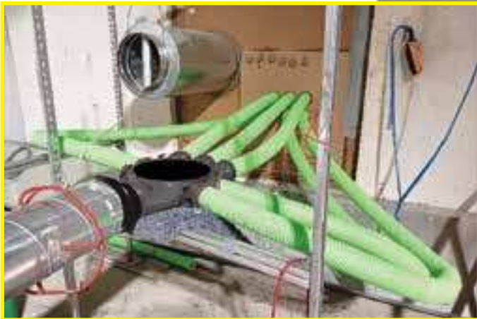
Imagen del ensayo de cajas termoplásticas
